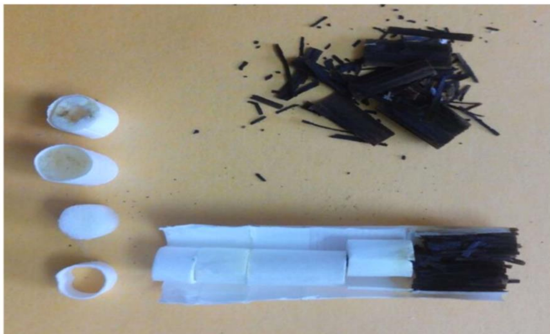
Рис. 11 Изменения в структуре компонент стиков после курительной сессии под воздействием температуры нагревателя
